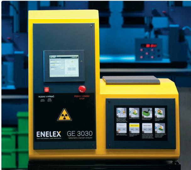
Прибор GE 3030 позволяет быстро измерять содержание зольных веществ в отобранных пробах угля прямо в рабочих помещениях и лабораториях. Это позволяет принимать оперативные решения и заключения, и, как результат, значительно увеличить эффективность производства и впоследствии снизить экономические расходы
